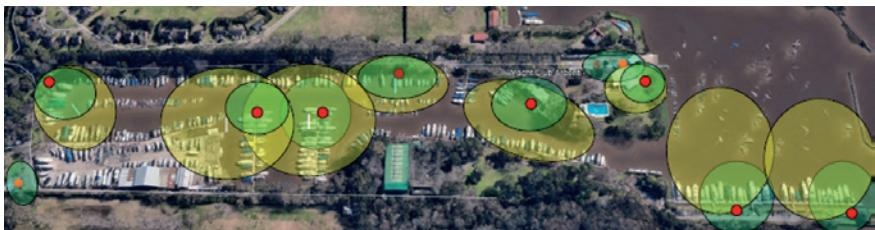
Y la tercera etapa fue la puesta en marcha y prueba del sistema. En base a los monitores realizados la Comisión de la Sede autorizó extender a 7 antenas repetidoras ampliando así el alcance del sistema wifi.
